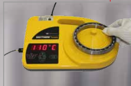
Ytimen ympärillä oleva magneettivuuo lämmittää kappaleen tasaisesti ja nopeasti.
