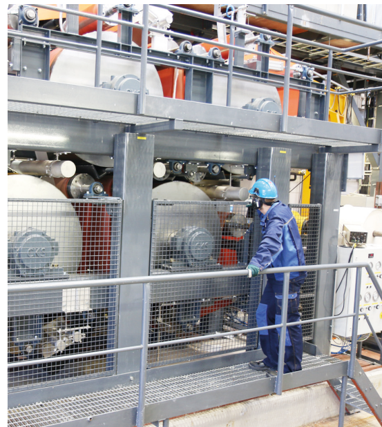
(Vas.) Kuva 1. Telan linjauksen mittaus.
