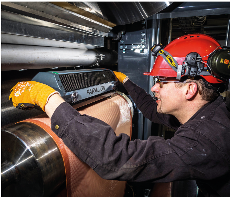
(Vas.) Kuva 1. Telan linjauksen mittaus.
