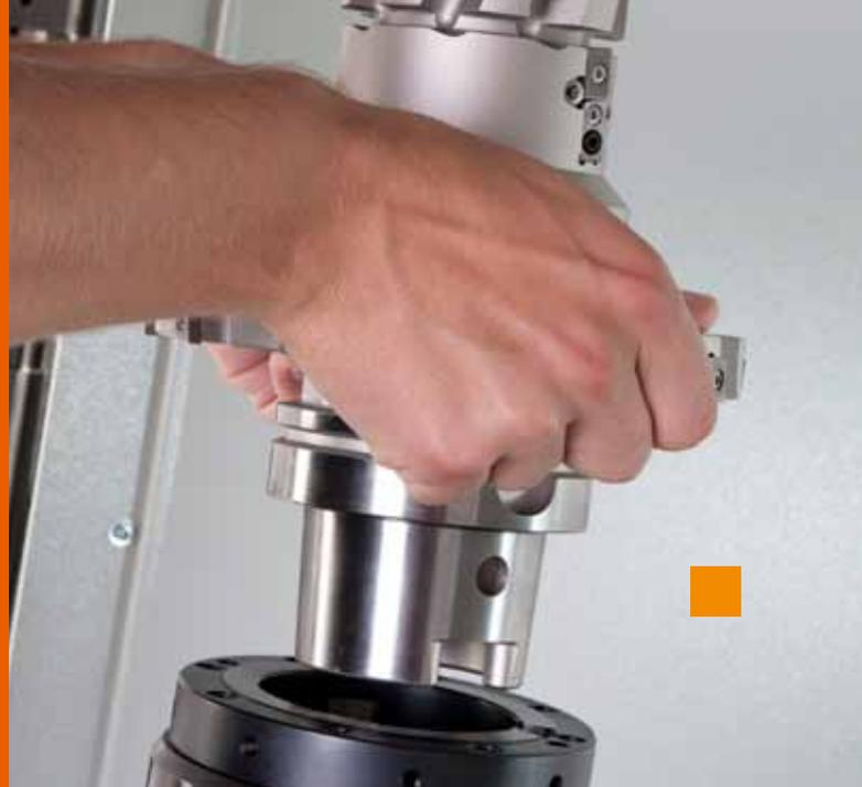
Ausgestattet mit einem schwingungsdämpfenden Mineralguss-Maschinenbett und einem leistungsstarken Antrieb bietet die VIRIO<sup>tool</sup> eine solide und effiziente Basis für das Auswuchten von schweren Bearbeitungswerkzeugen.
